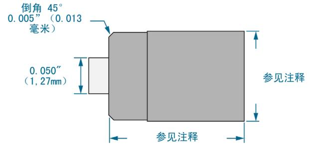
① **NOTE** 传感器采用压接方式。测量每个传感器主体，然后切割每个传感器口袋。将传感器安装到模具中后，将传感器尖端向下加工，使其与型腔表面齐平。成品传感器长度不得小于 0.177 英寸（4,496 毫米）。请参阅产品手册中的安装说明和规格。
