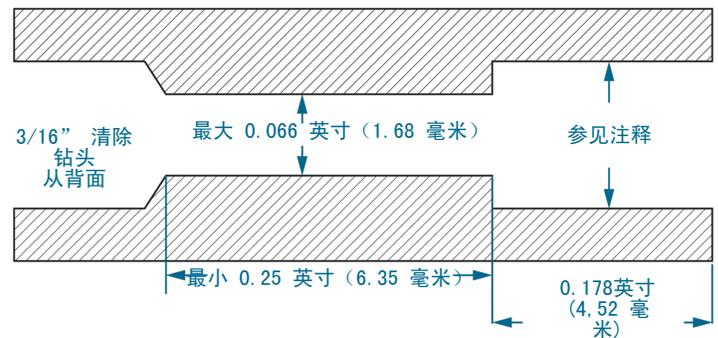
此处明确标出最大直径为0.066"（1,68 mm）英寸，确保在压力下仍可为传感器本体提供支撑如图所示，无需扩大线缆通道。
