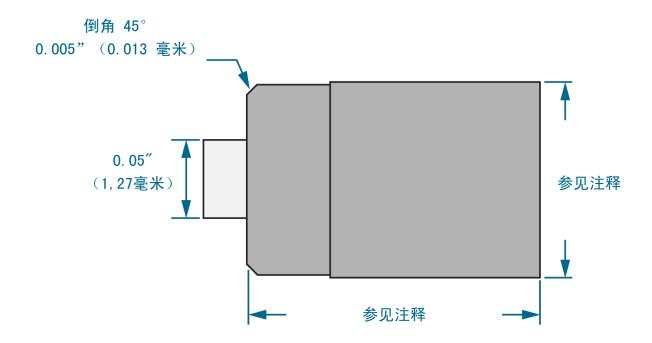
① NOTE 传感器采用压接方式。测量每个传感器主体,然后切割每个传感器套直径:请参阅"传感器套",页码 10。
