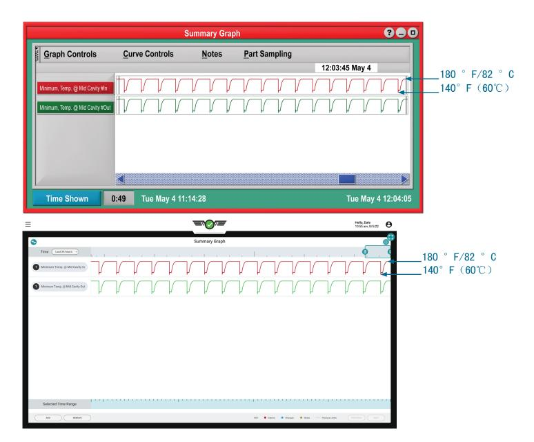
达到稳定的时间通常比预期的要长,因此在准备 "熄灯"操作流程时或在对零件进行采样进行测量之前,确定模具温度稳定性的概念非常重要。
