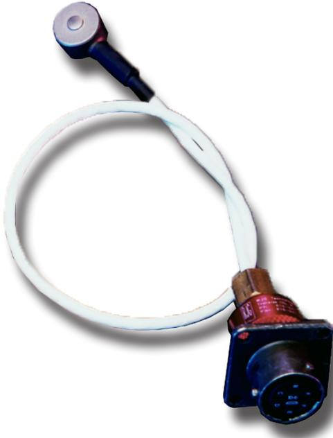
模拟单通道应变计传感器 T-445 是间接式（在引脚下）、0.625 英寸（15.88 毫米）按钮式腔体压力传感器，可承受高达 4,000 磅（17,79 kN）的力和温度高达 250 °F（121 °C — 标准传感器）或 425 °F（218 °C — 高温传感器）。
