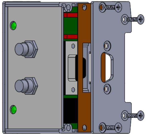
12. 使用两（2）个4-40 x 3/8“ 连接器螺钉固定模块的右侧连接器；使用两（2）个4-40 x 3/8“ 连接器螺钉固定模块的左侧连接器。将连接器螺钉拧紧至35 in.-oz.
