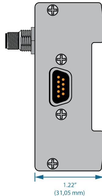
Lynx™ 屏蔽模拟输出模块OA1-M-V是DIN导轨安装模块，连接到成型机，以输出表示成型参数的0 - 10 V DC信号或作为外部机器传输。需要使用 ID7-M-SEQ（或 DIN/LX-D）模块将OA1-M-V 物理连接到 eDART® 或 CoPilot® 系统。这种导轨式模块为封闭屏蔽型，即使在恶劣的成型环境中也能保证高质量的数据传输。
