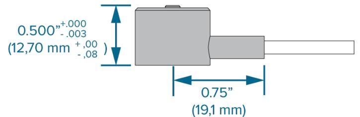
MCSG-B-159-4000 多通道、数字应变计、间接（下销）、0.625 英寸（15,88 毫米）按钮式腔压力传感器，设计用于 RJG eDART® 或 CoPilot® 工艺控制和监测系统。
