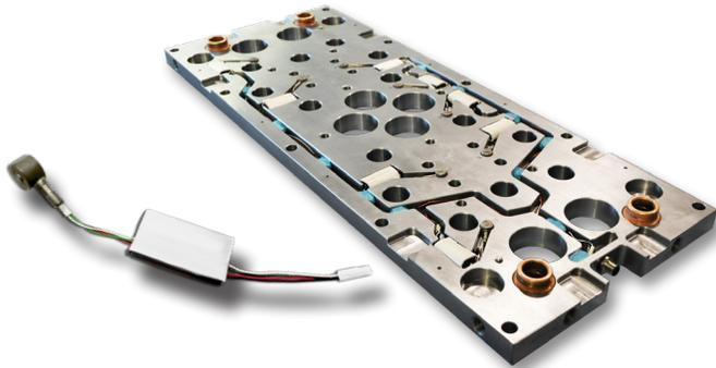
这 LES-B-127-50/125/500/2000 是多通道、数字应变计、间接（下销）0.50"（12,7毫米）按钮式腔压力设计用于 RJG eDART® 和 CoPilot 系统的传感器。一个 Lynx™ 连接器最多可连接 16 个传感器和一个系统 Lynx 端口（每个系统最多 32 个传感器——额外的传感器将需要额外的系统）；如果需要超过 32 个传感器，请联系 RJG 客户支持以获取更多信息。
