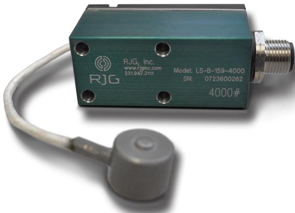
LS-B-159-4000 是一种单通道、数字应变计、间接（在销下）、0.625 英寸（15,88 毫米）按钮式腔压力设计用于 RJG eDART® 或 CoPilot® 过程控制和监测系统的传感器。
