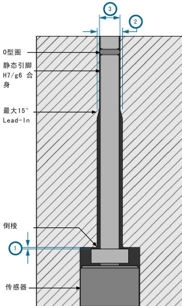
**CAUTION** 这些准则是针  $3/32''$  ( $2.5$ 毫米) 直径或更大。请联系RJG客户支持安装的静态引脚小于  $3/32''$  ( $2.5$ 毫米) 直径
