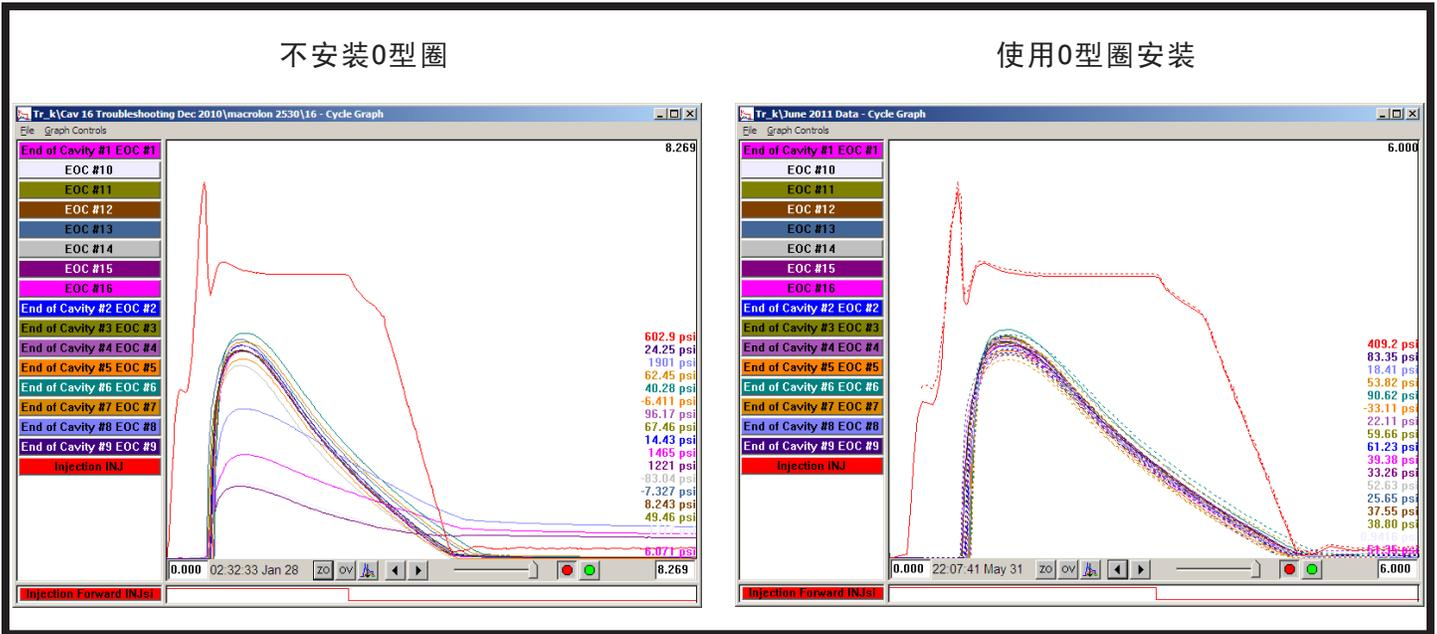
左上图：三个传感器读数过低，由于污染，没有安装O型圈。
