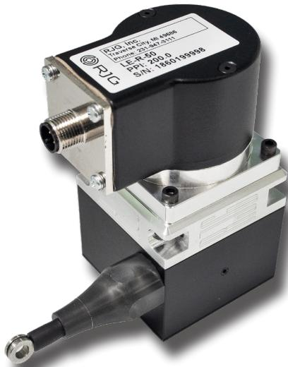
LE-R-50-REVB是可安装在成型机上的线性位置/速度传感器，设计用于eDART®和CoPilot®系统。行程/速度传感器可用于监视大多数注塑机上的标准螺杆位置和速度。
