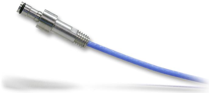
嵌入式安装的 4 mm 压电腔压力 RJG, Inc. 的传感器 6157 是一种单通道或多通道传感器，可以承受势力高达 29,008 psi (2,000 bar) 和最高温度 392 ° F (200 ° C)。
