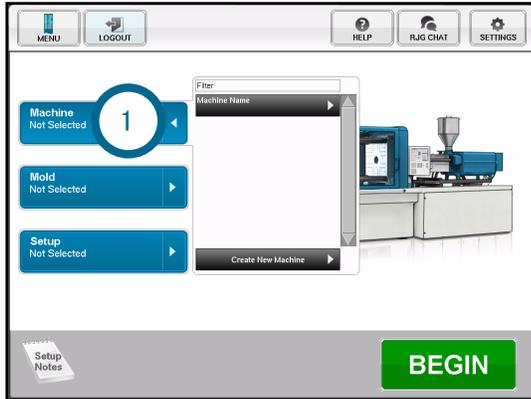
如果创建新机器，请输入机器名称/编号和螺丝直径。单击
